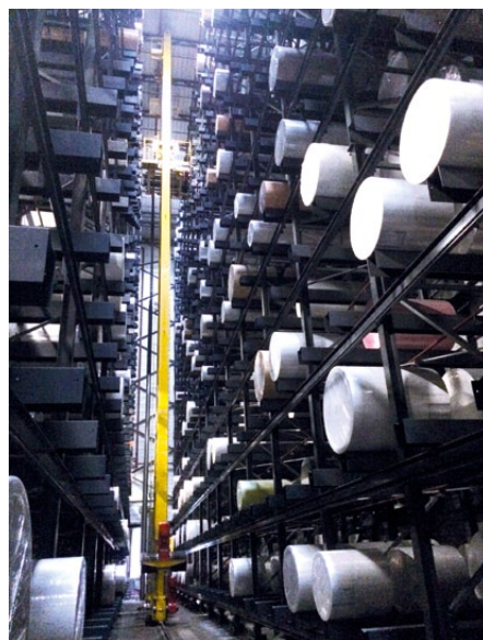
1 Durch dynamische Optimierung lässt sich eine effiziente und sichere Bewegung von RBG im Hochregallager erzielen.
